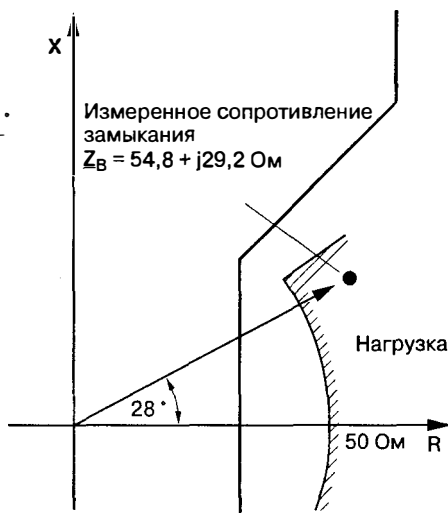
Рис. 7.10. Линия с трехсторонним питанием (см. рис. 7.9): диаграмма токов, напряжений и сопротивлений
