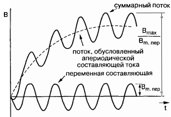
Рис. 5.5. Изменение потока намагничивания (индукции) в случае смещенного однопольярного тока КЗ
